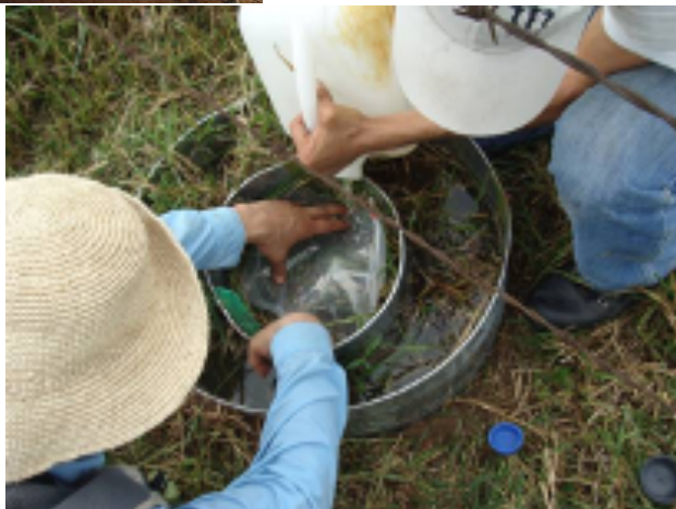
Figura 37. En las fotografías superiores, apiques y tomas de muestra en suelos lodosos, municipio de Valparaíso. En la fotografía inferior anillos Munz (infiltrómetro de doble anillo) para prueba de permeabilidad en campo.
