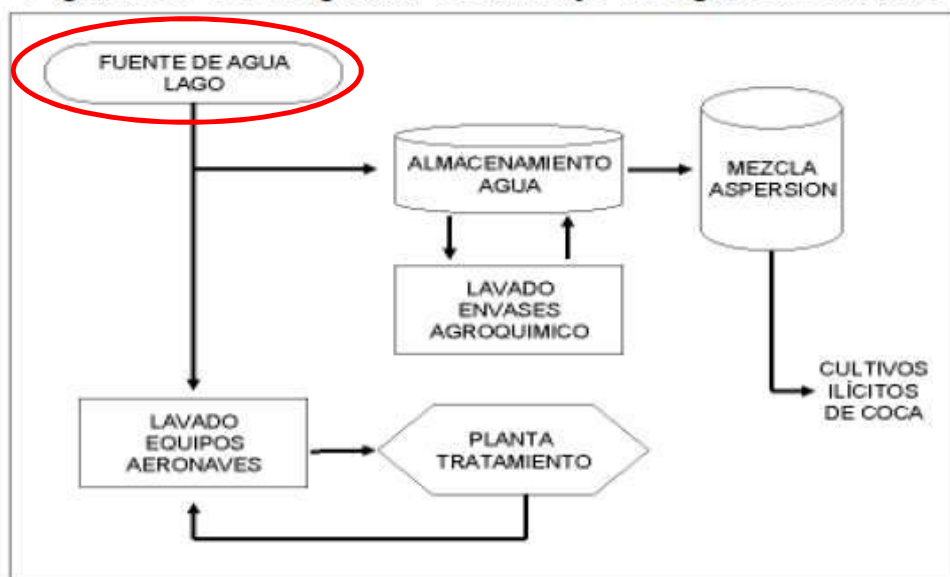
Figura 2.4-16 Diagrama de manejo de aguas residuales
