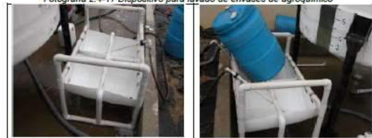
Fotografía 2.4-17 Dispositivo para lavado de envases de agroquímico
